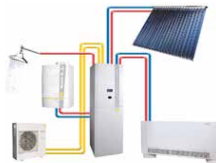
Schema idraulico di principio della centrale di calore LibraVario Aqua
