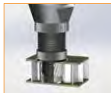
Deformare l'inserto per trazione del mandrino
