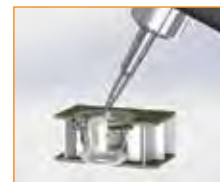
Depositare sul fondo del foro del collante
