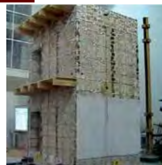
CON UTILIZZO SISTEMA CAM ® Accelerazione limite strumentale PGA = 1,20 G fessurazioni localizzate Riserve plastiche totalmente disponibili
