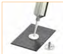
Depositare sulla superficie l'apposito collante.
