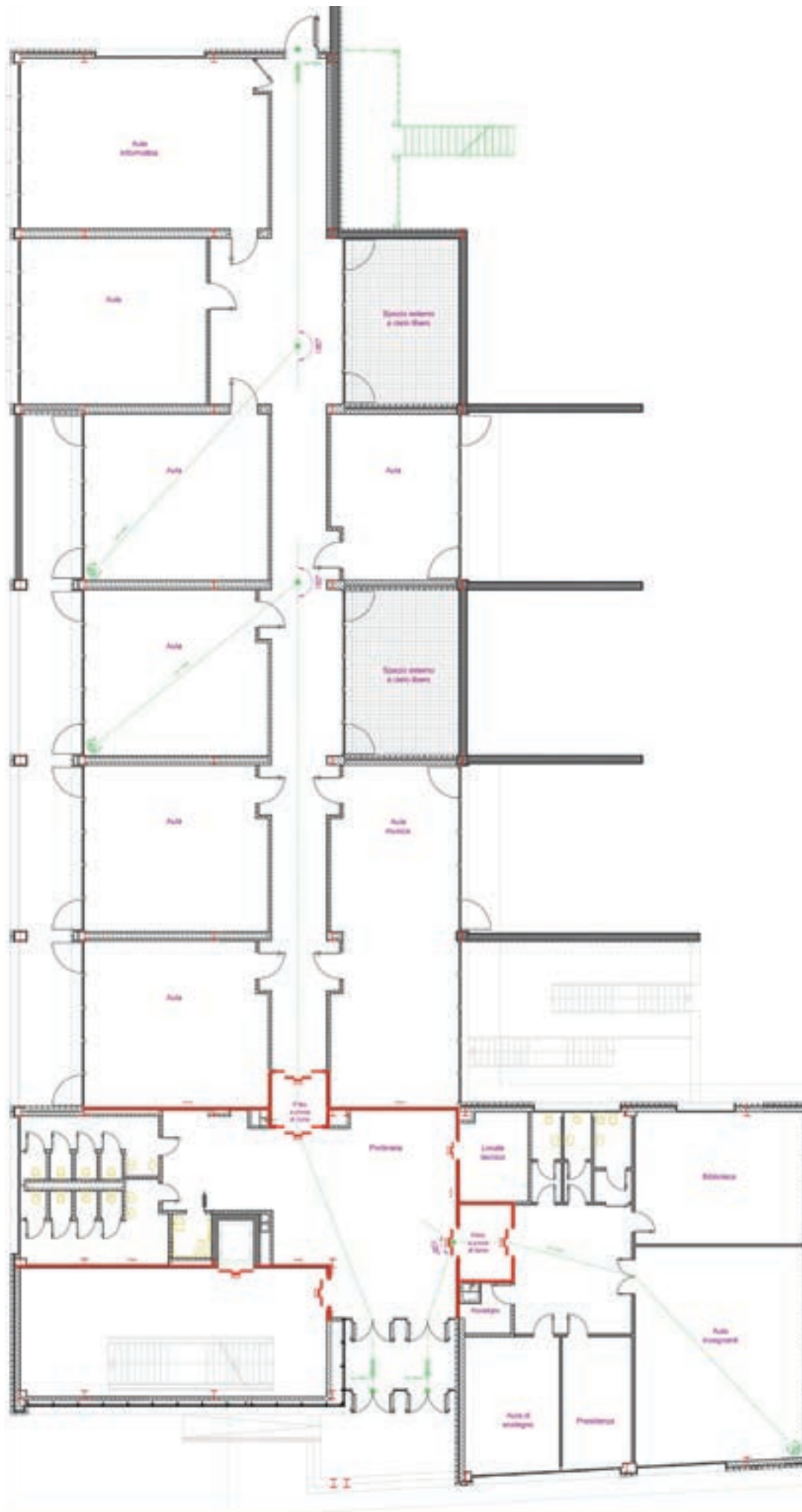
VIE D'ESODO ED USCITE INDIPENDENTI - PIANO TERRA
