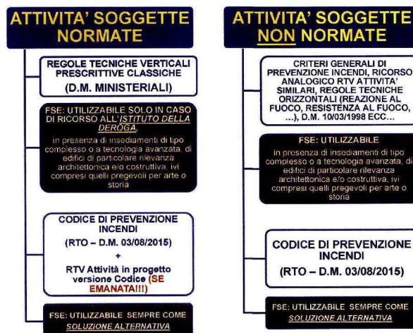
Figura 4 – Progettazione Antincendio: approcci e metodi
