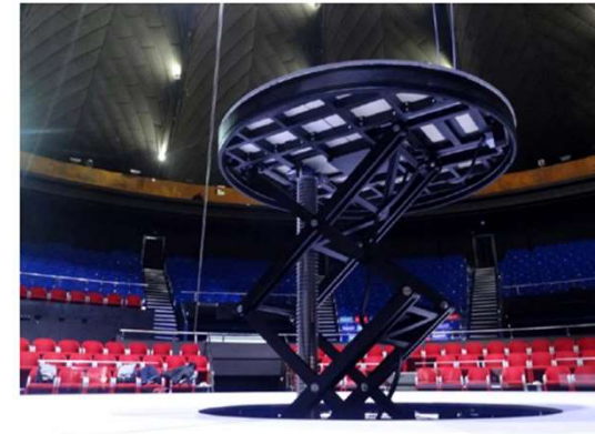
Figura 14 – Esempio di piattaforma a spostamento verticale
