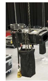
Figura 13 - Macchine scenotecniche: paranchi (c.d. motori)
