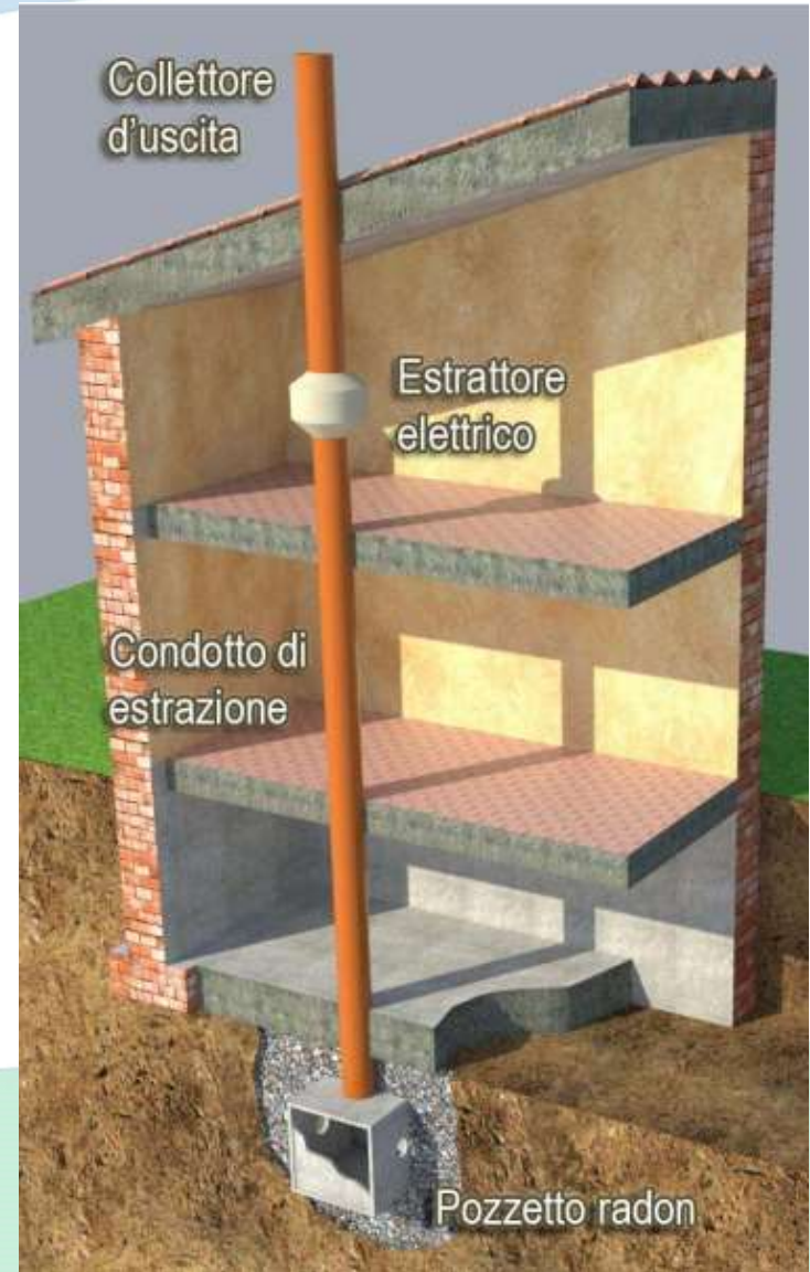
Depressurizzazione suolo con pozzetto drenante interno
