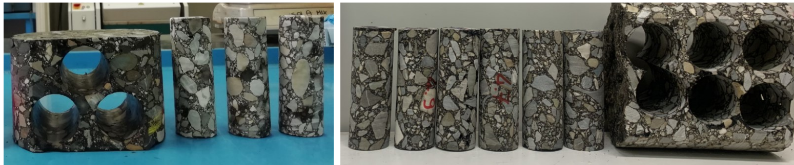
Carotaggio orizzontale di provini di diametro 38 ed altezza 110 mm
