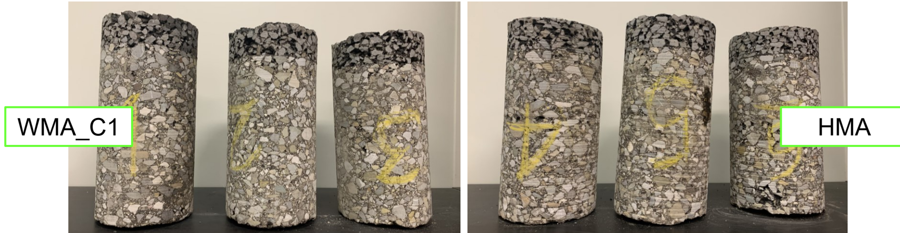
Carotaggio orizzontale di provini di diametro 38 ed altezza 110 mm
