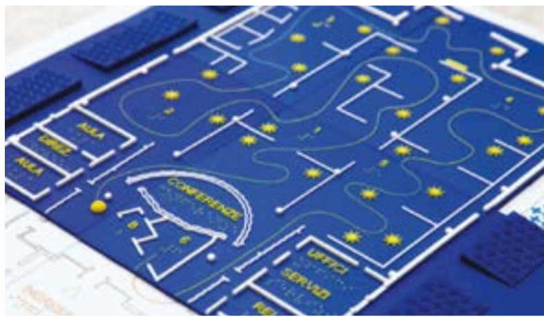
Fig. 4. Mappa tattile del Museo della Tecnica Elettrica (MTE) di Pavia realizzata tramite tecnologia di stampa 3D FDM
