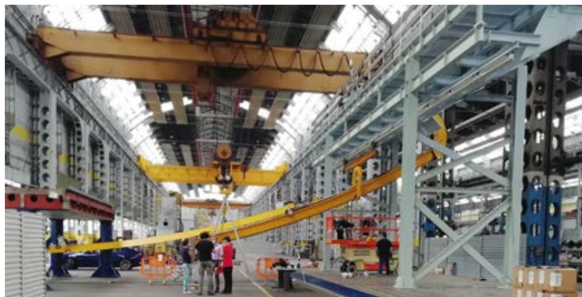
Braccio meccanico estensibile del robot-inspection (immagine fornita da IIT - Camozzi).
