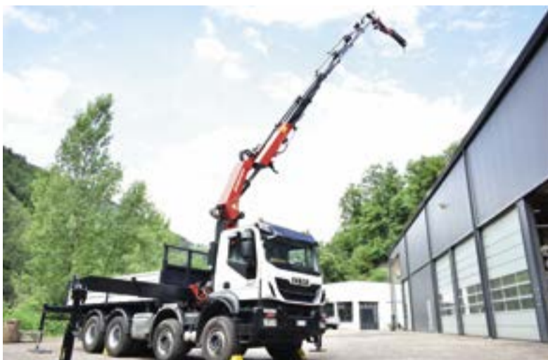
Figura 2. Gru a bracci articolati con jib e argano (fonte PALFINGER ITALIA SpA)
