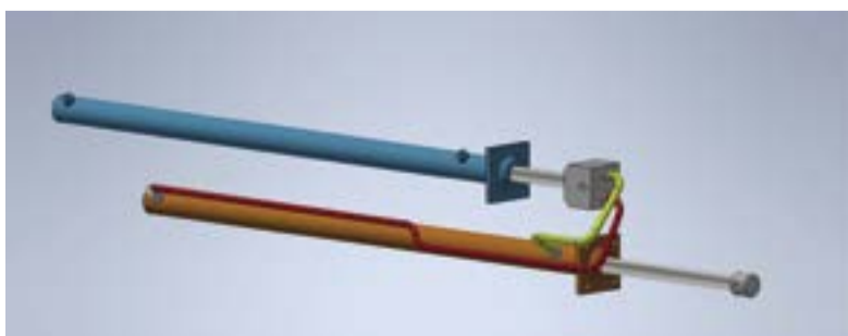
Figura 4. Martinetti sfilato con alimentazione interna (fonte Ecologia Soluzione Ambiente SpA)
