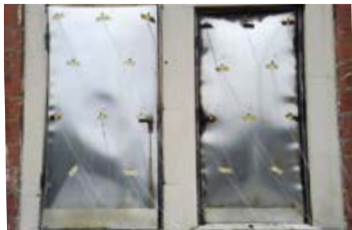
Foto 6. Test fuoco rei antisismica - 134 min
