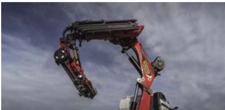
Figura 1. Gru a bracci articolati con jib e argano (fonte PALFINGER ITALIA SpA)
